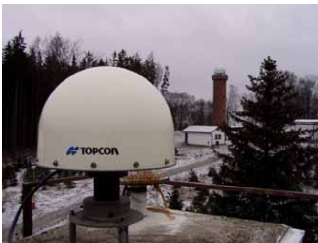
GNSS přijímač Topcon NetG3 (na počítači v RACKu) s anténou Topcon CR-G3 na stanici GO Pecný (v pozadí věž trigonometrického bodu Pecný)
