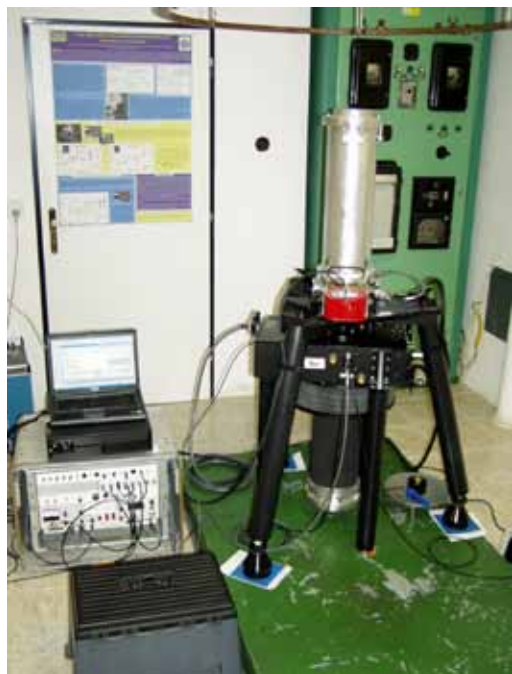
Absolutní gravimetr FG5 No. 215 (vlevo) a elektronika supravodivého gravimetru OSG 050 (vpravo).
